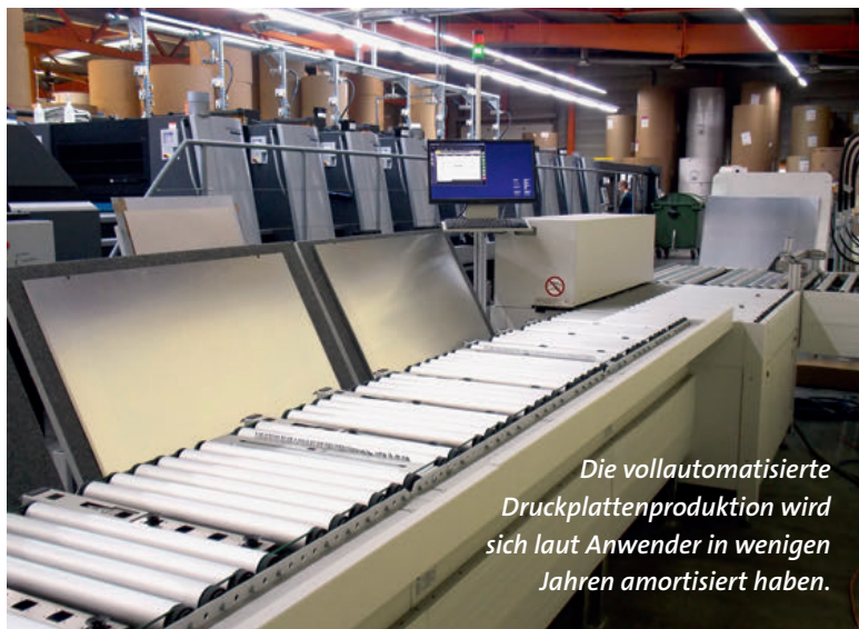
Das Abkantsystem mit Plattensorter, Nela SF-Bender, ist bei der Druckerei Sandler inline an die beiden Kodak CTP-Linien angebunden.
