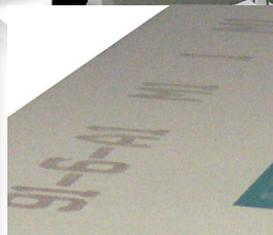
Optional kann ein Aufdruck des Barcodeinhaltes mit einem Inkjet-Drucker direkt auf die Druckplatte erfolgen.
